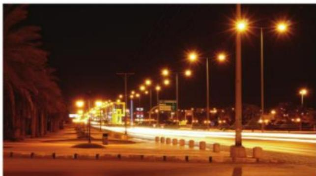
L'ampoule d'une lampe à vapeur de sodium contient du sodium gazeux à haute ou basse pression. Ces lampes produisent une lumière jaune orangé et servent pour l'éclairage public. Elles offrent en effet une bonne qualité de vision et un coût d'utilisation peu élevé.
