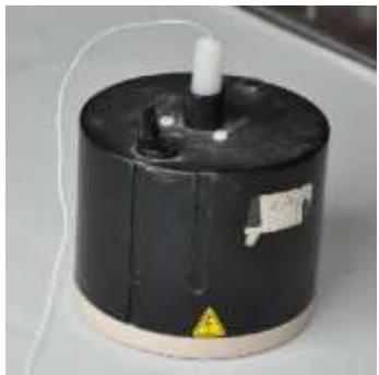
On appelle « table à coussin d'air » un support parfaitement rectiligne, sur lequel peut se déplacer des mobiles « autoporteurs », disposant d'une soufflerie. Le « coussin d'air » entre le mobile et la table permet au premier de glisser sur la seconde à la manière d'un aérogissoir, donc quasiment sans frottement.
