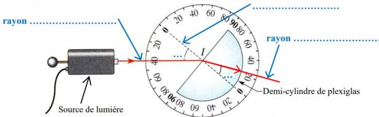
1.2/ Réaliser le montage ci-dessus et faire varier l'angle d'incidence  $i_1$  en faisant tourner l'ensemble {rapporteur/plexiglas} afin de mesurer l'angle de réfraction  $i_2$ . Relever les valeurs de l'angle de réfraction qui correspondent et compléter le tableau suivant :
